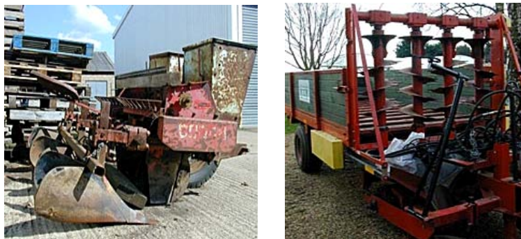
Ημιαυτόματη μηχανή φύτευσης πατάτας και αυτόματη μηχανή φύτευσης 4 γραμμών.
