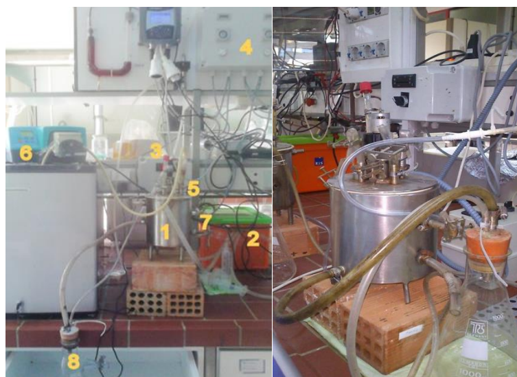
Εικόνα 2.7 : Η πειραματική διάταξη αναερόβιας συγχώνευσης στο στάδιο της μεθανογένεσης περιλαμβάνει: 1. Αντιδραστήρας CSTR, 2. Υδατόλουτρο, 3. Σημείο αέριας δειγματοληψίας, 4. Συσκευή μέτρησης βιοαερίου, 5. Σωληνάκι τροφοδοσίας, 6. Αντλία τροφοδότησης, 7. Σωληνάκι δειγματοληψίας, 8. Δοχείο απορροής.
