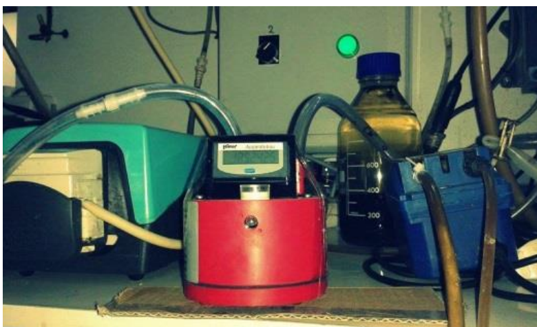
Εικόνα 2.8: Συσκευή μέτρησης βιοαερίου Ritter .
