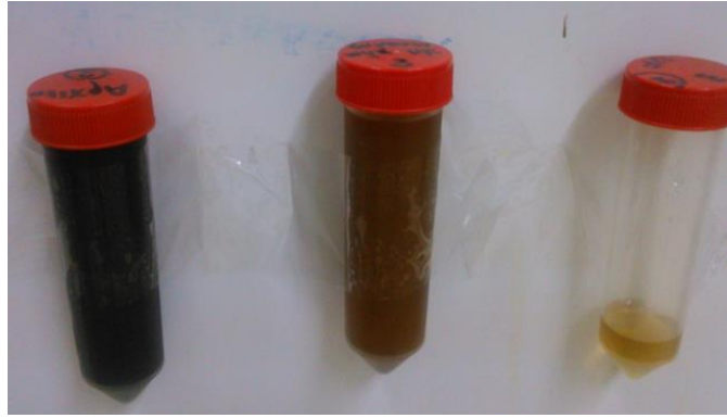
Εικόνα 4.5: Το αρχικό δείγμα, το συμπύκνωμα και το διήθημα μετά από UF μεμβράνη.
