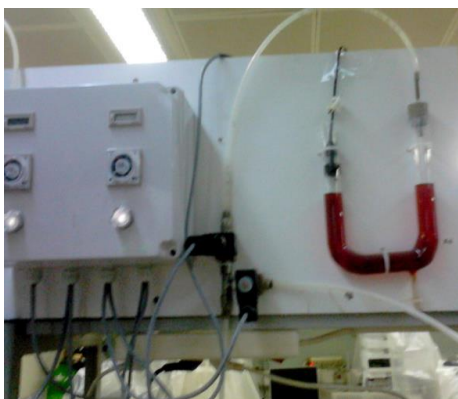
Εικόνα 2.3: Σύστημα μέτρησης παραγωγής βιοαερίου.
